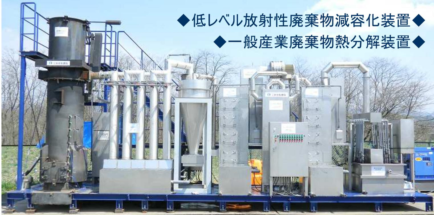
本熱分解装置は燃料を必要としない有機物処理装置であり、一般産業廃棄物をはじめ除染作業で発生する放射性廃棄物をも熱分解によりセラミック化して1/100~1/500に減容・減量でき、また熱分解による排気は煙も臭いもなく、ダイオキシンや放射性物質を出さない画期的な装置です。(放射性物質はセラミックに封じ込みます)
